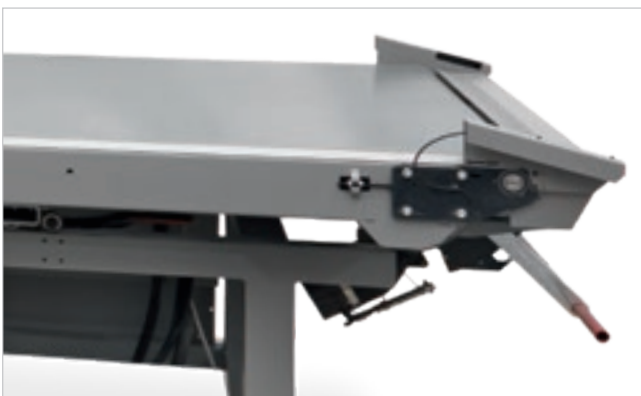
Collettore di aspirazione posizionato in fondo al tappeto.
