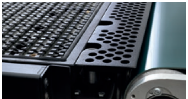
Sistema di aspirazione trucioli disposto tra la macchina ed il tappeto di scarico, garantisce la massima pulizia dei pezzi.
